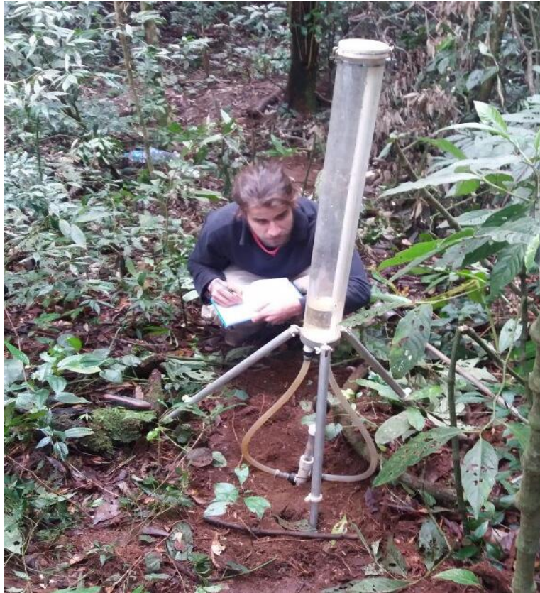
Figura 20: Medição da condutividade hidráulica do solo com permeâmetro de Guelph
