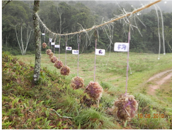
Figura 2: Coletores feitos com Sphagnum seco para medir a interceptação horizontal (nevoeiros) em diferentes vertentes numa região de Floresta Ombrófila Densa Montana, Nova Friburgo-RJ.
